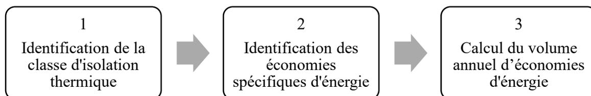
1. La classe d'isolation thermique du bâtiment est identifiée par l'intermédiaire du certificat de performance énergétique ou, à défaut, par l'intermédiaire de l'année de construction du bâtiment en tenant compte d'une éventuelle modernisation partielle, antérieure du bâtiment (voir tableau 1).
