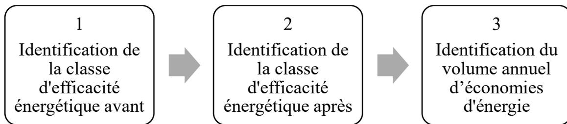
1. La classe d'efficacité énergétique avant est celle de l'appareil remplacé. Le minimum pris en compte étant la classe B, même si l'appareil est d'une classe inférieure.
