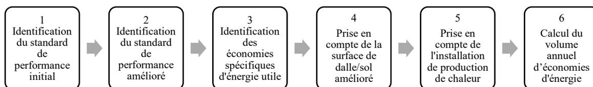
1. Le standard de performance de la dalle inférieure contre zone non chauffée ou du sol dans son état initial est identifié à l'aide du tableau 1 par l'intermédiaire de la valeur U de la dalle inférieure contre zone non chauffée ou du sol dans son état initial ou de l'année de construction du bâtiment.
