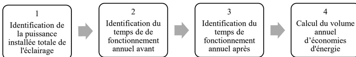
1. La puissance installée totale de l'éclairage  $P$  [W] est identifiée d'après les puissances des lampes connectées à la minuterie.
