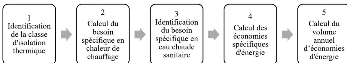
1. La classe d'isolation thermique du bâtiment est identifiée par l'intermédiaire du certificat de performance énergétique ou, à défaut, par l'intermédiaire de l'année de construction du bâtiment en tenant compte d'une éventuelle modernisation partielle, antérieure du bâtiment (voir tableau 1).
