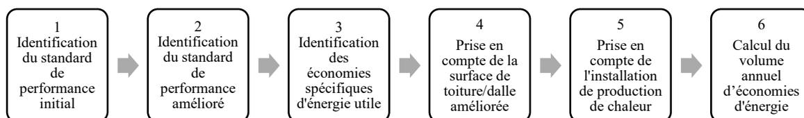
1. Le standard de performance de la toiture ou de la dalle supérieure contre zone non chauffée dans son état initial est identifié à l'aide du tableau 1 par l'intermédiaire de la valeur U de la toiture ou de la dalle supérieure contre zone non chauffée dans son état initial ou de l'année de construction du bâtiment.
