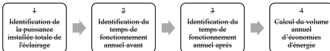
1. La puissance installée totale de l'éclairage  $P$  [W] est identifiée d'après les puissances des lampes connectées au détecteur de mouvement.
