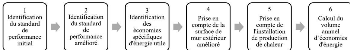
1. Le standard de performance du mur extérieur dans son état initial est identifié à l'aide du tableau 1 par l'intermédiaire de la valeur U du mur extérieur dans son état initial ou de l'année de construction du bâtiment.
