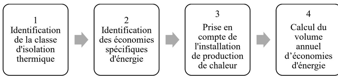
1. La classe d'isolation thermique du bâtiment est identifiée par l'intermédiaire du certificat de performance énergétique ou, à défaut, par l'intermédiaire de l'année de construction du bâtiment en tenant compte d'une éventuelle modernisation partielle, antérieure du bâtiment (voir tableau 1).
