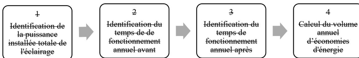
1. La puissance installée totale de l'éclairage  $P$  [W] est identifiée d'après les puissances des lampes connectées à la minuterie.
