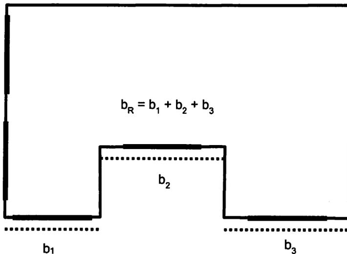
Figure 1 - Détermination de la façade principale
